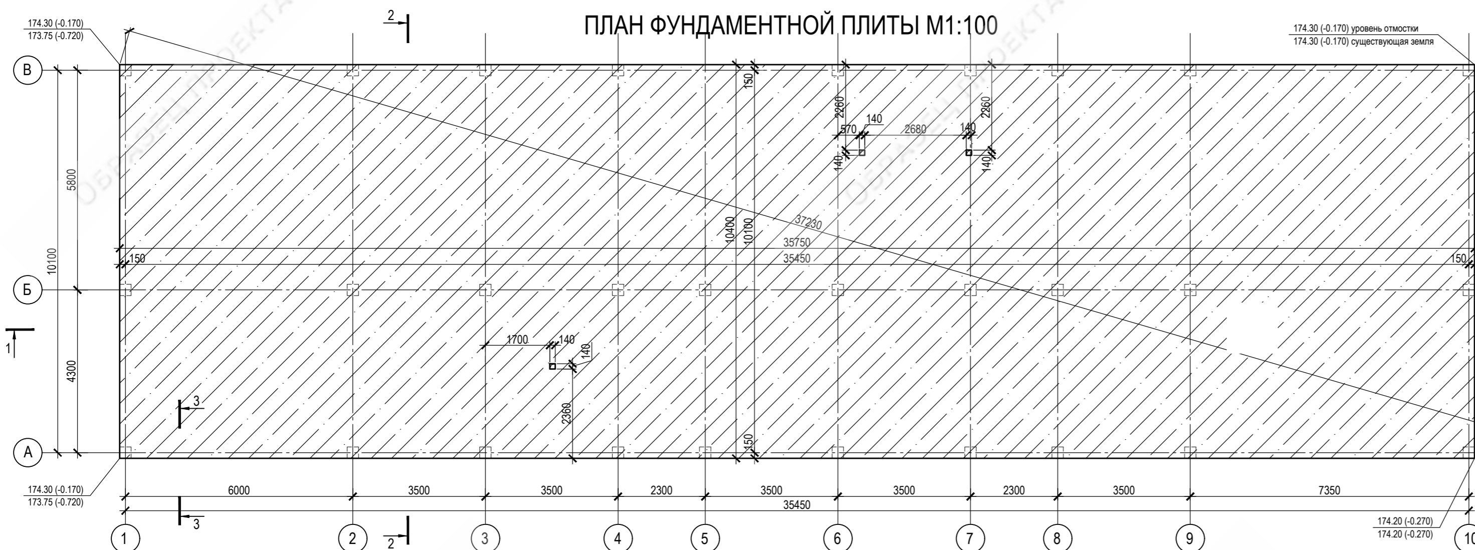
ПЛАН РАСКЛАДКИ ОСНОВНОЙ НИЖНЕЙ И ВЕРХНЕЙ АРМАТУРЫ М1:100
